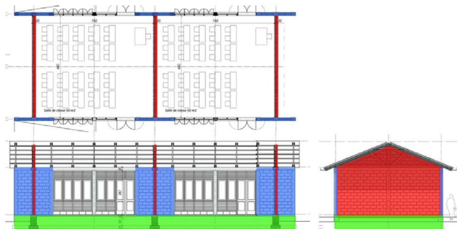
Figure 1 Concept structurel 2 salles de classe
