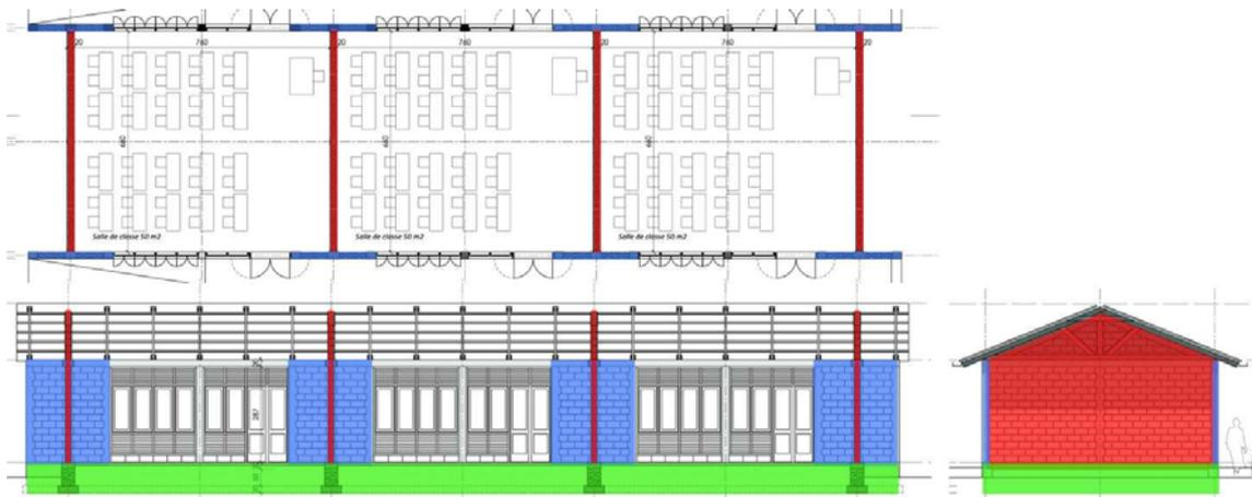
Figure 2 Concept structurel 3 salles de classe
