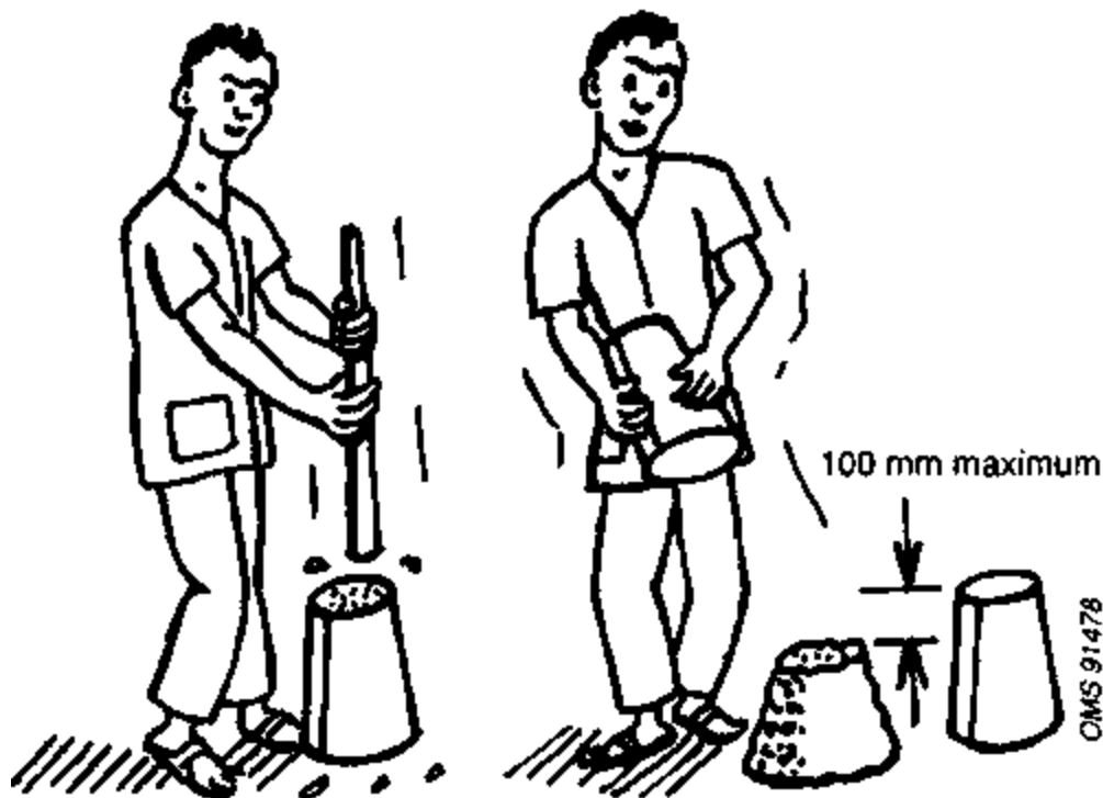
Fig. 7.18. Contrôle de la teneur en eau par cône d'affaissement
